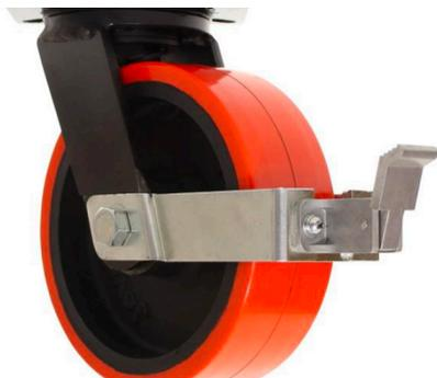
Rodaja giratoria, herraje en placa de acero, en color negro. Doble rodamiento giratorio cónico y axial, eje de rueda atornillado. Placa de fijación cuadrada, núcleo de rueda de hierro fundido. Bandaje en poliuretano STD-95 para carga pesada. Freno frontal de rueda.
