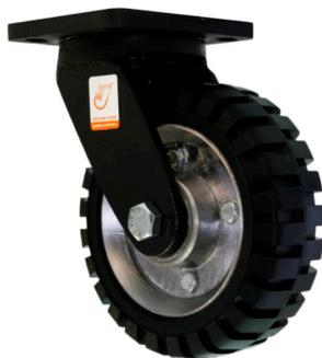
Rodaja giratoria, herraje en placa de acero en color negro, rodamiento giratorio de bolas, eje de rueda atornillado, placa de fijación rectangular. Núcleo de rueda de aluminio, bandaje en hule sólido para carga media pesada.
