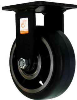
Rodaja fija, herraje en placa de acero, en color negro, eje de rueda atornillado. Placa de fijación rectangular, núcleo de rueda de hierro colado, bandaje en hule sólido para carga medio pesada.
