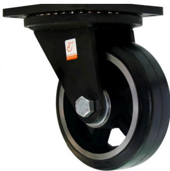
Rodaja giratoria, herraje en placa de acero en color negro, rodamiento giratorio de bolas, eje de rueda atornillado, placa de fijación cuadrada. Núcleo de rueda hierro fundido, bandaje en hule sólido para carga pesada.
